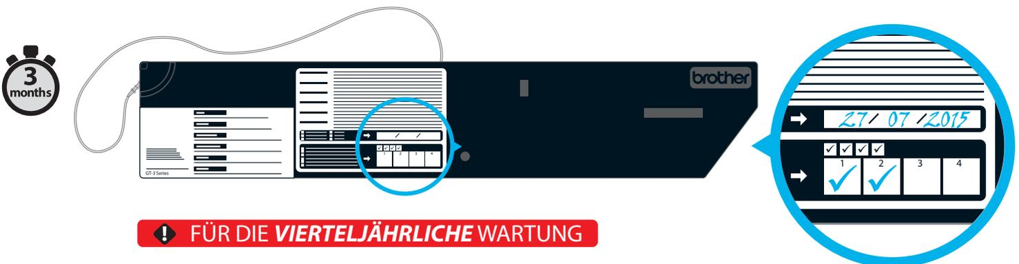
Die Wartungskartusche für CMYK sollte alle 3 Monate für die **Farbschlauchreinigung** benutzt werden. Dies ist der einzige **einfache Weg**, die kleinen Farbschläuche innerhalb der Maintenance Einheit zu reinigen und somit eine gute Saugleistung der Pumpe zu garantieren, so dass die Druckköpfe weiterhin einwandfrei gereinigt werden.
